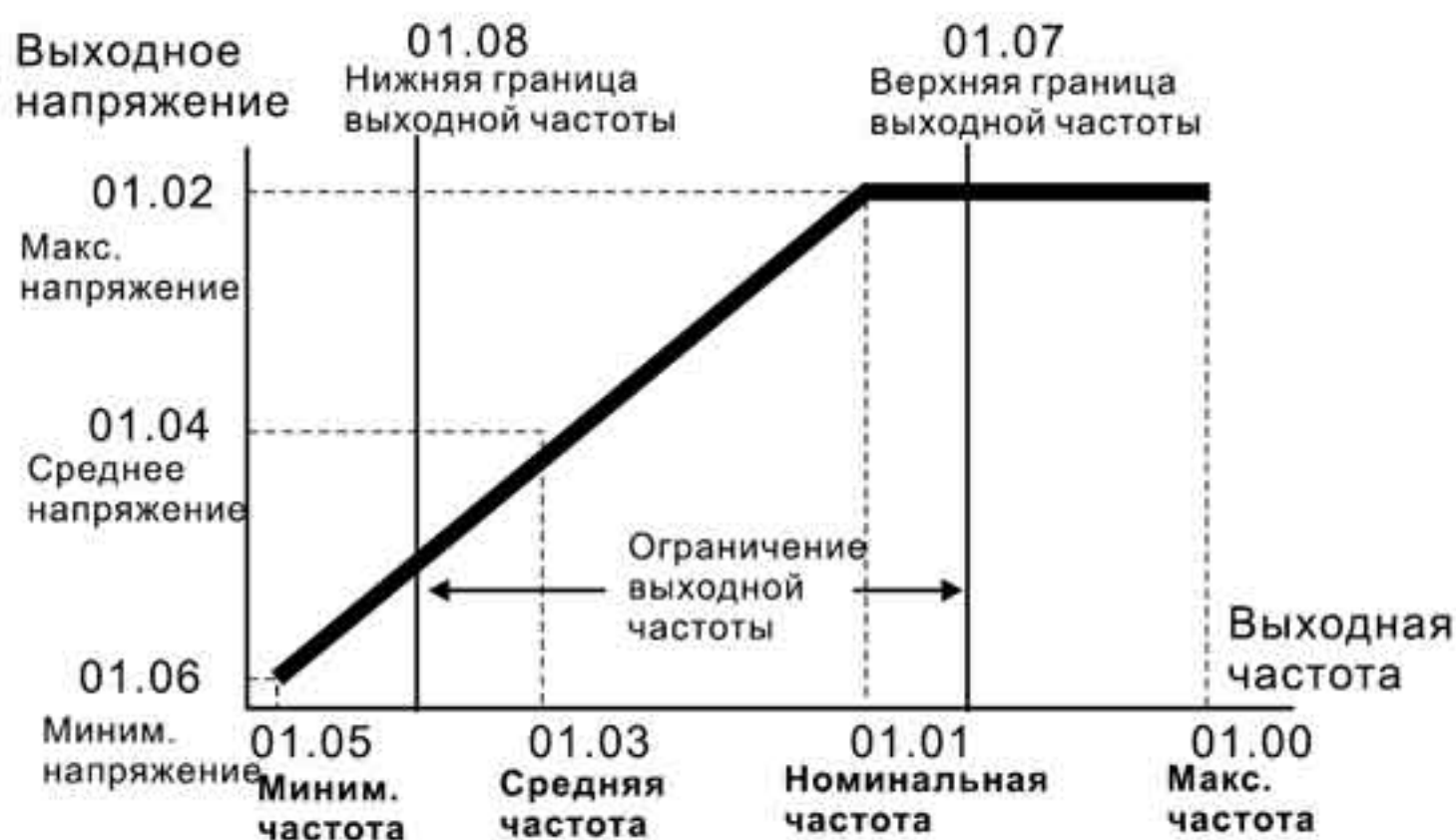
Типовая зависимость V/f
